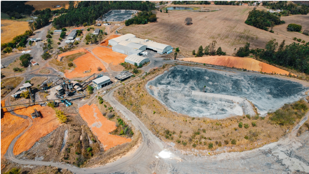
Imagem 1: Mina Amando Simões, poço 08, onde se extrai carvão mineral em Figueira-PR em mineração subterrânea pelo método de câmaras e pilares. Fonte: Acervo institucional do Instituto Internacional ARAYARA (2025), crédito Luz Dorneles.
